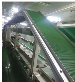
防滑皮带斜坡线
